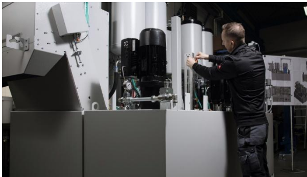
Mitarbeiter der Lehmann-UMT GmbH bei der Installation der Filterdöme
