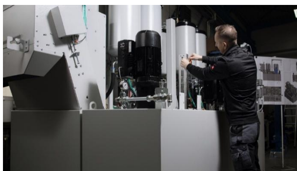
Un employé de Lehmann-UMT GmbH en train d'installer les dômes filtrants
